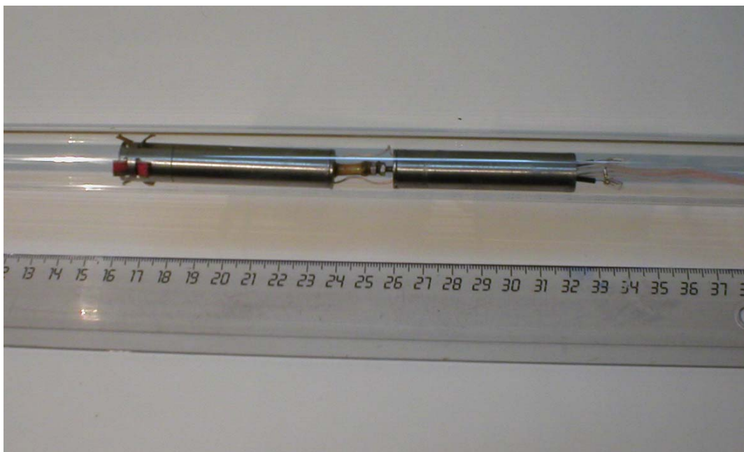
Рис. 2.15. Миниатюрный внутритрубный робот с управляемым упором.
